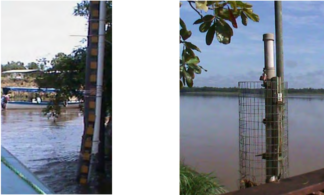
Figura 3.3–1. Hidrómetro automático en embarcadero de Nuevo Rocafuerte
